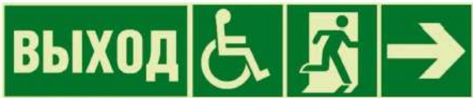
Рисунок 5 - Пример комбинации эвакуационных знаков
